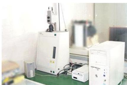
**全自动显微镜：**全自动显微镜是一种采用了先进的集散控制技术和模块化嵌入式结构，从而实现载物台 XYZ 三轴控制及光源明亮度的自动调节，并通过软件实现全景自动扫描、自动拼图、自动回位、同步浏览、远程遥控等全自动化功能，以达到提高工作效率目的的光电算一体化的高科技产品。具有可靠性强、稳定性好、精度高等特点，是显微图像自动分析设备不可缺少的组件。
