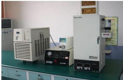
**全自动氨基酸分析仪：**利用样品各种氨基酸组分的结构不同、酸碱性、极性及其分子大小不同，在阳离子交换柱上将它们分离，采用不同 pH 值离子浓度的缓冲液将各氨基酸组分依次洗脱下来，再逐个以另一流路的茚三酮试剂混合，然后共同流至螺旋反应管中，于一定温度下（通常为 115~120℃）进行显色反应，形成在 570nm 有最大吸收的蓝紫色产物。
